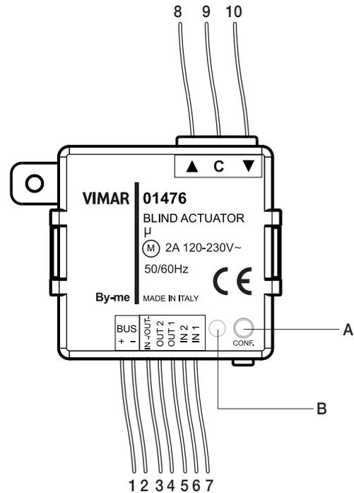
A: Pulsante di configurazione • Configuration button • Bouton de configuration
