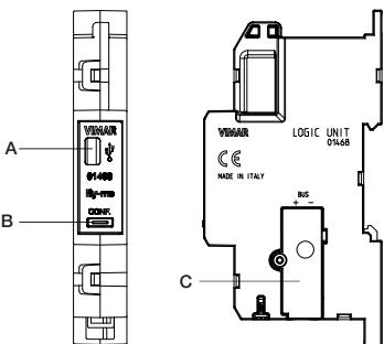
A: Connettore micro USB - Micro USB connector - Connecteur micro USB
