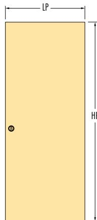
**Nota:** Panoul de usa destinat modelului Syntesis®Line se va freza in lungul profilului superior, asa cum arata desenele. (exceptie facand usile din sticla).
