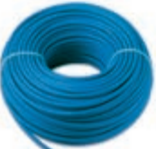
01840.E.B Cavo per diffusione sonora sistema Bus By-me, 2x0,50 mm², con guaina in LSZH, Classe CPR Eca, idoneo per installazione con cavi energia di I Categoria (U0 = 400 V), blu - 100 m
