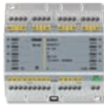
01470.1 Modulo 9 ingressi e 8 uscite preprogrammate per applicazioni residenziali o alberghiere, uscita relè NO 16 A 120-230 V~ 50/60 Hz programmabili con funzione luci, tapparelle con orientamento lamelle, comando locale, 6 moduli da 17,5 mm
