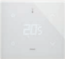
▲ 21514.S.70 Termostato touch screen (riscaldamento e condizionamento), comando STAR configurabile, controllo ON/OFF (classe I, contributo 1%), PWM, PID (classe IV, contributo 2%), interfacciabile con attuatore 01466.1 per termostato d'ambiente modulante (classe V, contributo 3%), 1 ingresso per sensore 20432, 19432 o 14432 o sensore filare 02965.1, 1 ingresso digitale programmabile, retroilluminazione a LED RGB, bianco diamante - 2 moduli. Prof.tà: 30,2 mm
