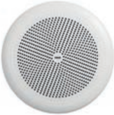
01906 Diffusore passivo sonoro IP55 8 Ω 30 W, installazione su pareti leggere e controsoffitto IP55. Prof.tà: 70 mm
