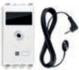
20584.1.B Per trasmissione comandi By-me a ricevitore IR, con cavetto 3 m, bianco. Prof.tà: 40 mm
