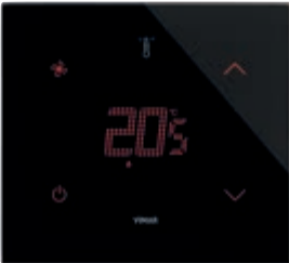
▲ 21514.F.76 Termostato touch screen (riscaldamento e condizionamento), comando FAN-COIL a 3 velocità e proporzionale, controllo ON/OFF (classe I, contributo 1%), PWM, PID (classe IV, contributo 2%), interfacciabile con attuatore 01466.1 per termostato d'ambiente modulante (classe V, contributo 3%), 1 ingresso per sensore 20432, 19432 o 14432 o sensore filare 02965.1, 1 ingresso digitale programmabile, retroilluminazione a LED RGB, nero diamante - 2 moduli. Prof.tà: 30,2 mm
