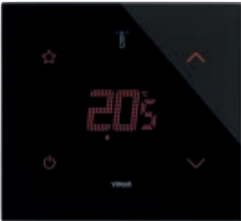
▲ 21514.S.76 Termostato touch screen (riscaldamento e condizionamento), comando STAR configurabile, controllo ON/OFF (classe I, contributo 1%), PWM, PID (classe IV, contributo 2%), interfacciabile con attuatore 01466.1 per termostato d'ambiente modulante (classe V, contributo 3%), 1 ingresso per sensore 20432, 19432 o 14432 o sensore filare 02965.1, 1 ingresso digitale programmabile, retroilluminazione a LED RGB, nero diamante - 2 moduli. Prof.tà: 30,2 mm
